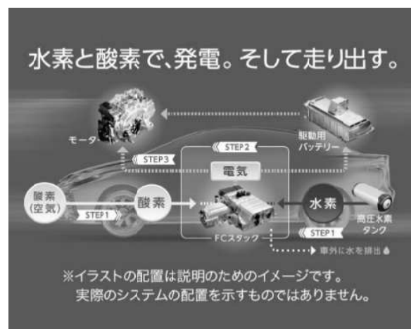
図3 燃料電池自動車の仕組み 1
